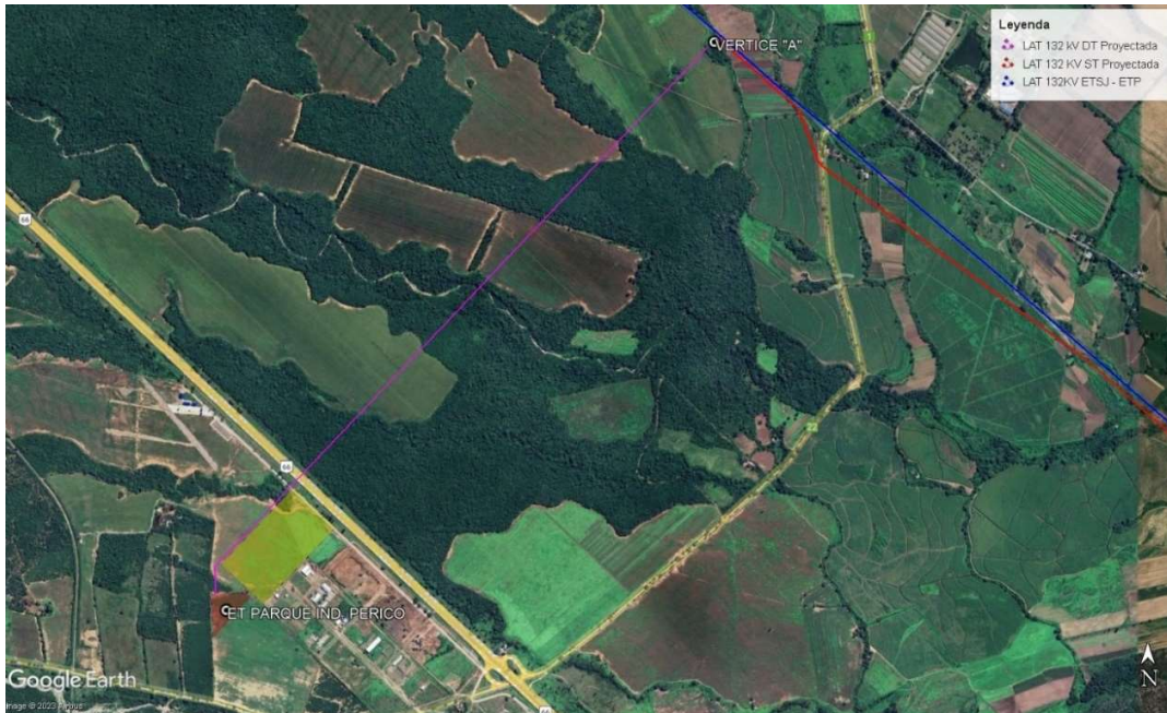
Vértice "A" LAT 132 kV ET San Juancito – ET Parque Industrial Perico
